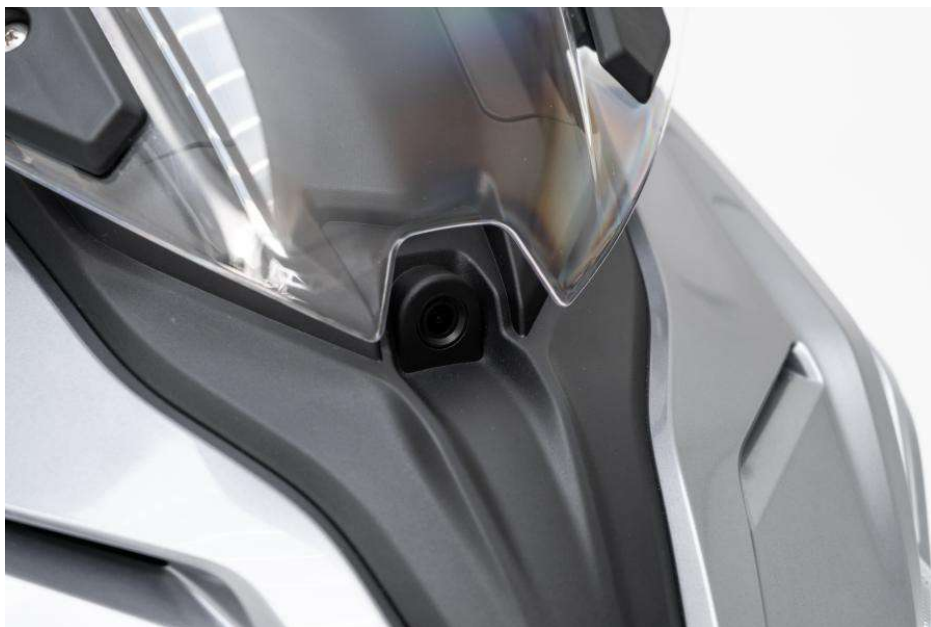
Telecamera frontale sotto il parabrezza
