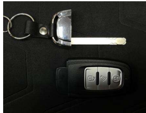
Telecomando keyless con chiave meccanica integrata
